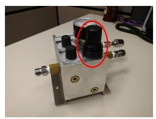
FIGURE 4 TOPSIDE VIEW OF WITT BLENDER ADJUSTABLE REGULATOR
