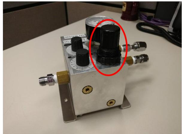
FIGURE 4 TOPSIDE VIEW OF WITT BLENDER ADJUSTABLE REGULATOR
