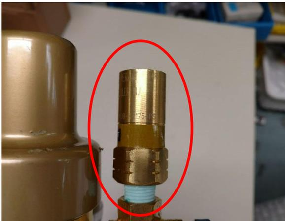
FIGURE 5 PRESSURE RELIEF VALVE (PRV)
